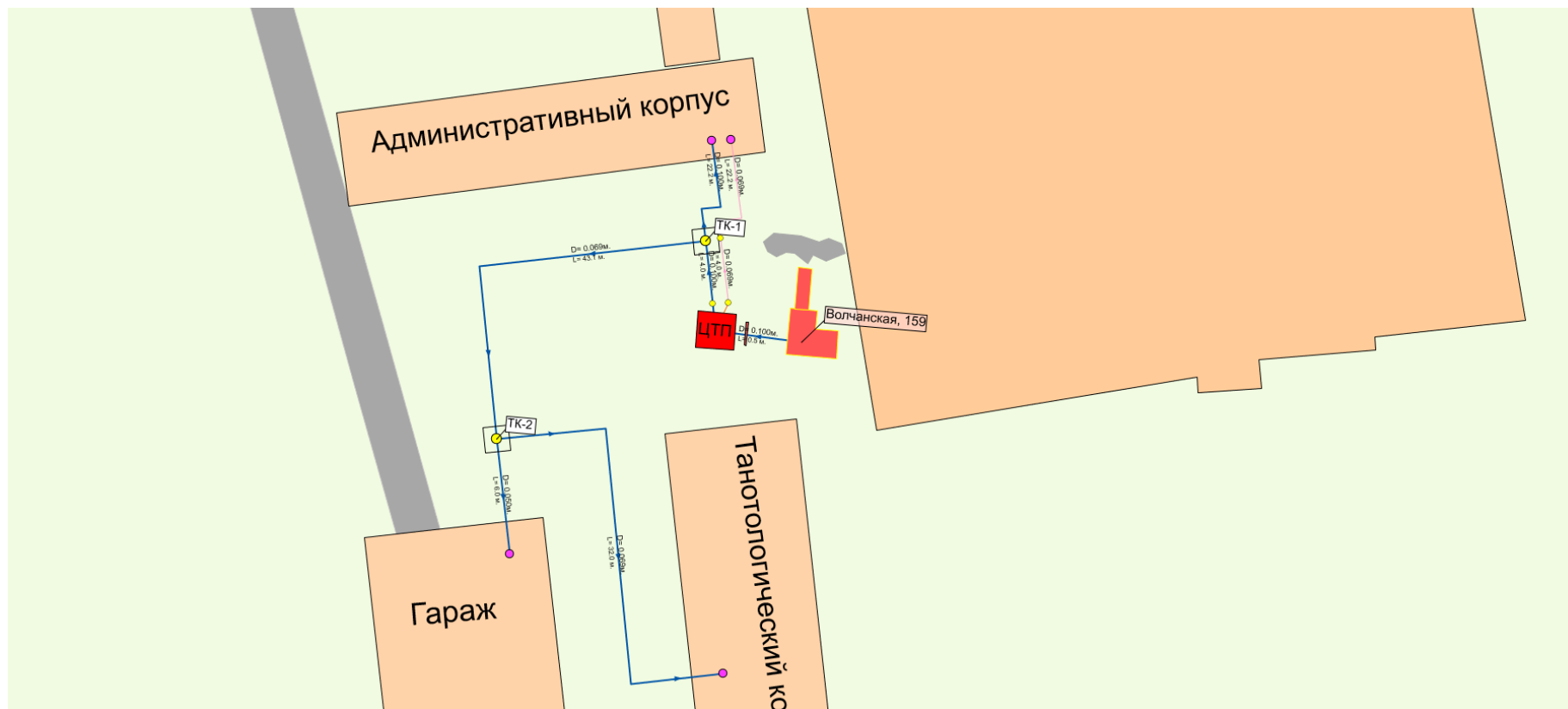
Рисунок 1.9.29 Схема магистральных сетей от котельной «Волчанская, д. 159»
