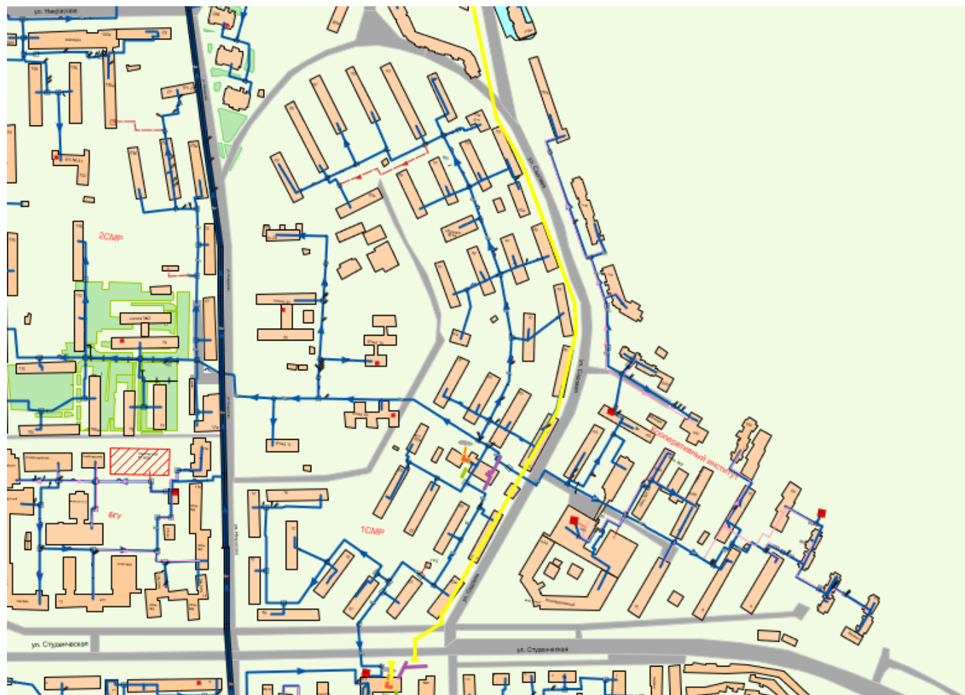
Рисунок 1.9.4 Схема магистральных сетей от котельной «1 CMP»
